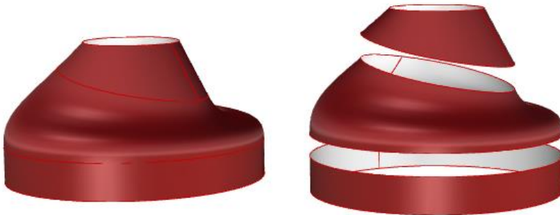
図 (70): ポリサーフェスは、共通のエッジが許容範囲内で完全に一致した結合されたサーフェスから作成されます。
