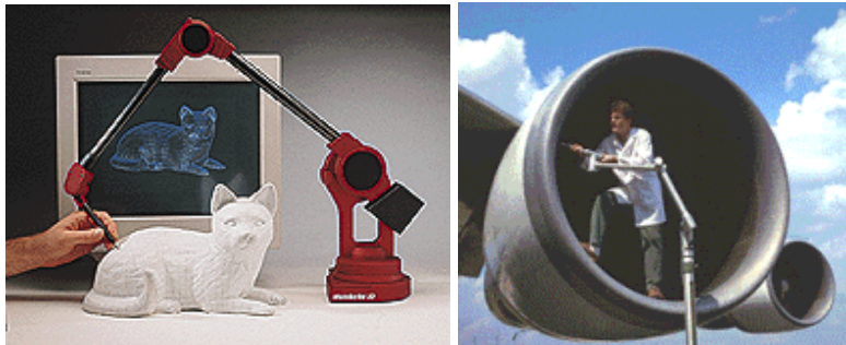
MicroScribe および Faro Space Arm の 3-D デジタイザの直接サポート
